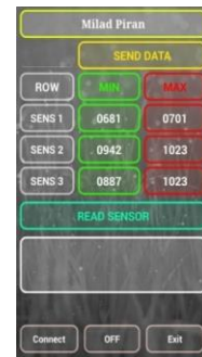
شکل ۳: نمای نرم افزار با ثبت کمترین و بیشترین خمش
